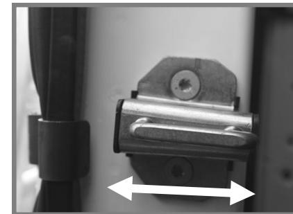
**F/** Si l'étrier de l'échelle heurte la portière lors de sa fermeture, il est possible de régler la position du verrou de la portière (Photo ci-dessus) afin de lui donner plus de jeu.
