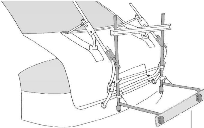
Um die Pulverbeschichtung nicht zu zerkratzen setzen Sie erst die Kunststoffhülse dann die Schelle auf das Lastenrahmenrohr. Jetzt kann die Zusatzbeleuchtung befestigt werden.
