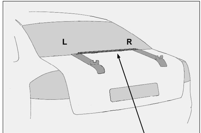
8. Setzen Sie die Verbindungsstrebe (7) auf die vormontierten Schloßschrauben in den oberen Montageelementen
