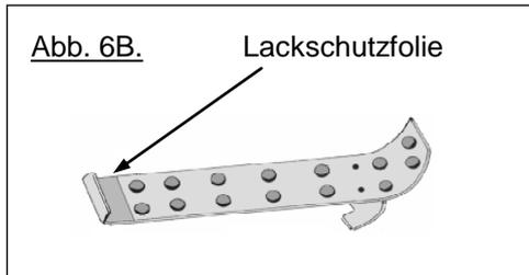
7. Hängen Sie die oberen Montageelemente ( 14 / 15) am Kofferdeckel so ein, daß sie sich genau über den Lackschutzfolien befinden. Bitte beachten Sie hierbei unbedingt die Markierungen „ L“ und „ R“ für das linke und rechte Montageelement.
