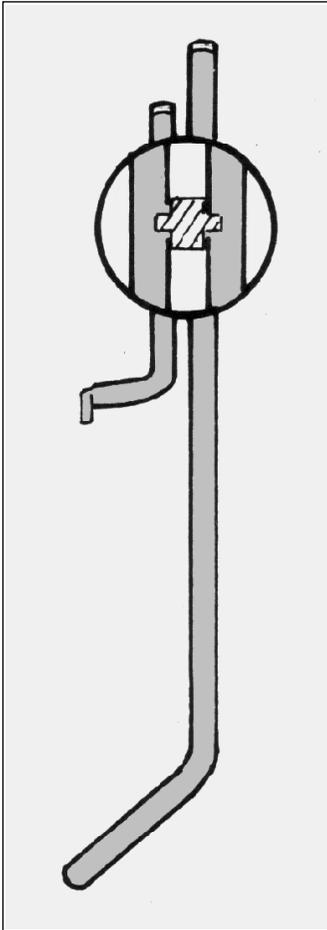
9.2. Der Fixierstift (F) ist werkseitig in die richtige Position eingepreßt. Die Lochposition sollte unter keinen Umständen verändert werden.
