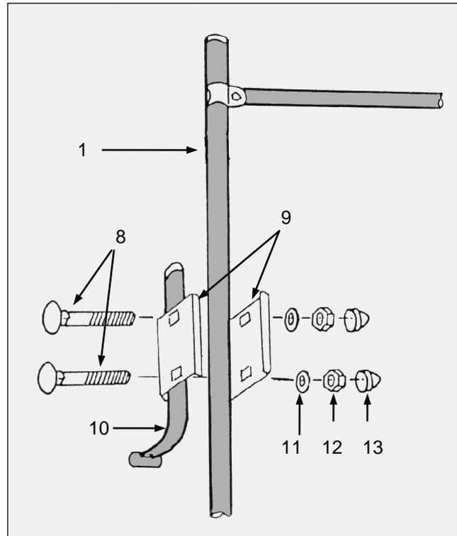
9.3. Danach umschließen Sie die verbundenen Rohre mit den Klemmböcken (9) gem. Abb, und ziehen die Muttern (12) vorerst nur leicht an.
