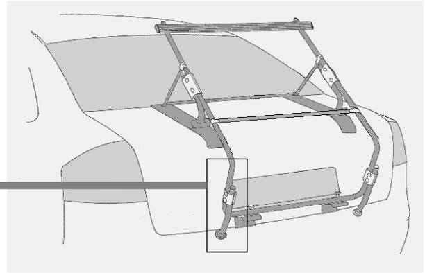
13. Befestigen Sie die Belastungsverstärker unbedingt bei geschlossener Heckklappe. Sie müssen fest auf der Stoßstange aufstehen, ohne sie einzudrücken. Bitte kleben Sie die Lackschutzfolien (28) unterhalb der Gelenkfüße im Bereich des Druckpunktes auf die Stoßstange.
