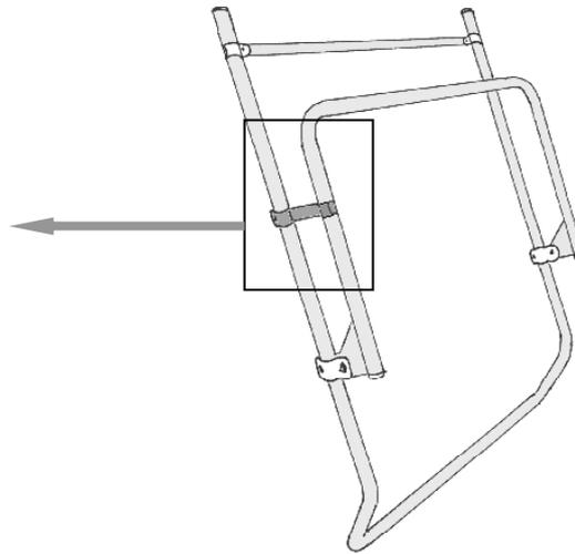
Dieser Halter **ersetzt** die in einigen Montageanleitungen abgebildeten älteren Versionen, bzw. die früher eingesetzten Gummispannbänder mit Kunststoffhaken.
