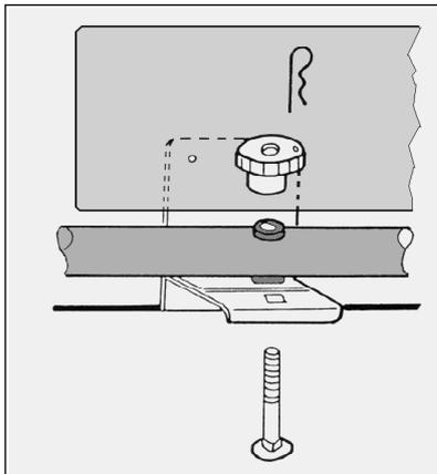
9.3. Die oberen Montageelemente können bei halb geöffneter Heckklappe ausgehängt werden.
