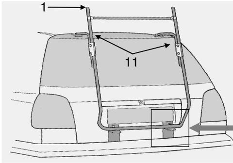
4. Die transparenten Lackschutzfolien wurden bereits werkseitig auf die unteren Montageelemente geklebt. Sie dürfen keinesfalls entfernt werden. Hängen Sie die Elemente in die leicht geöffnete Heckklappe ein und schieben Sie sie hinter das Kennzeichen (siehe Abb. 4.1.). Richten Sie die unteren Montageelemente (3) so aus, daß die Vierkantstanzungen der unteren Montageelemente (3) genau unter den Bohrungen des Trägerrohres liegen.
