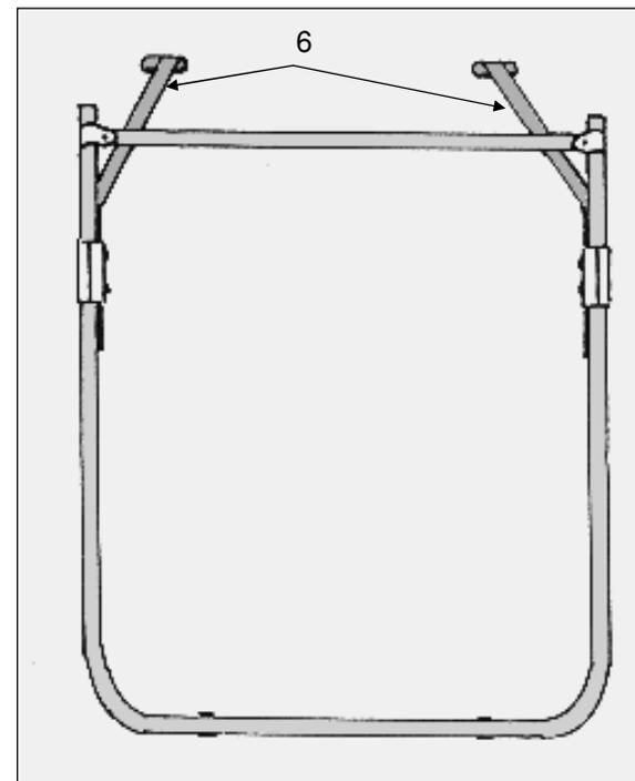
3.4. Die Trägerlänge ist jetzt fahrzeugspezifisch genau angepasst. Schwenken Sie die Tragarme (6) etwas nach innen ein und hängen Sie das Trägergestell (1) anschließend in die Aufnahme der oberen Montageelemente (4).
