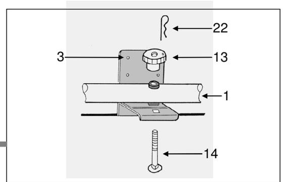
4. Befestigen Sie die Gummiformteile (24) an den unteren Montageelementen gem. Abb. und hängen Sie sie in die leicht geöffnete Heckklappe ein. Richten Sie die unteren Montageelemente (3) so aus, daß die Vierkantstanzungen der unteren Montageelemente (3) genau unter den Bohrungen des Trägerrohres liegen.
