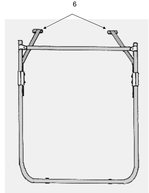
3.4. Die Trägerlänge ist jetzt fahrzeugspezifisch genau angepasst. Schwenken Sie die Tragarme (6) etwas nach innen ein und hängen Sie das Trägergestell (1) anschließend in die Aufnahme der oberen Montageelemente (4) .
