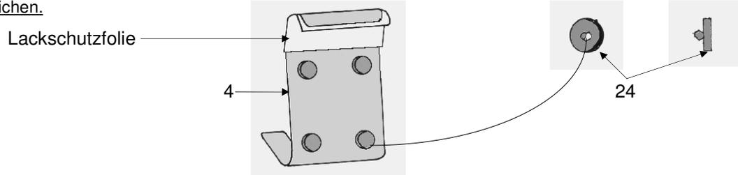
2. Hängen Sie die oberen Montageelemente (4) in die halb geöffnete Heckklappe ein. Der Abstand zwischen den Innenkanten der oberen Montageelemente muß (Siehe Tabelle) betragen.
