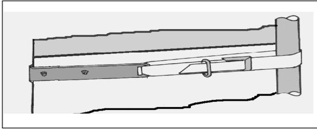
9.1. Lösen Sie die Spannung der Querlasthaltebänder und hängen Sie sie anschließend bei leicht geöffneter Heckklappe aus.
