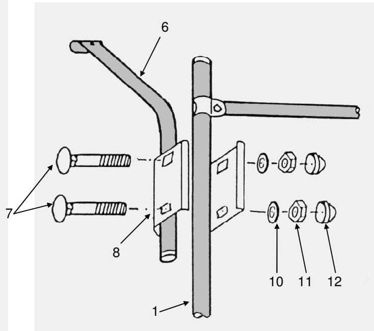
3.3. Danach umschließen Sie die verbundenen Rohre mit den Klemmbacken (8) gem. Abb, und ziehen die Muttern (11) vorerst nur leicht an.
