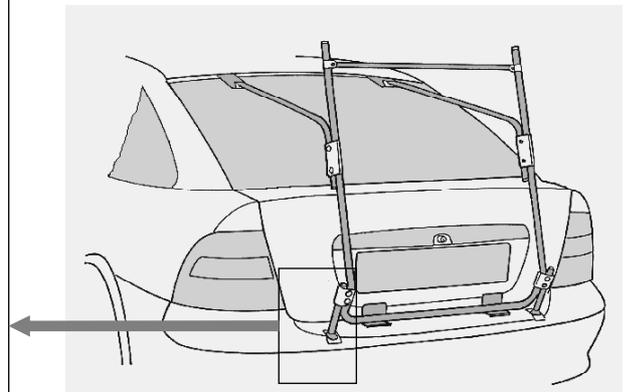
6. Befestigen Sie die Belastungsverstärker (5) gemäß Abbildung. Sie müssen fest auf der Stoßstange aufstehen. Bitte kleben Sie die Lackschutzfolien (26) unterhalb der Gelenkfüße im Bereich des Druckpunktes auf die Stoßstange.
