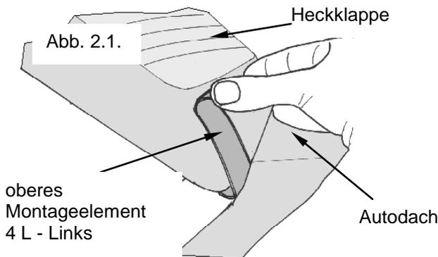
**Tip:** Sie können beide Montageelemente (4L u. R) bei halb geöffneter Heckklappe von einer Seite aus einhängen.
