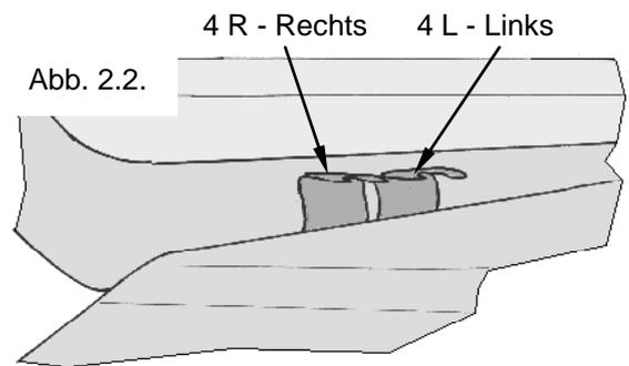
**Wichtiger Hinweis:** Halten Sie die Montageelemente beim Öffnen und Schließen der Heckklappe fest. Ein verrutschtes Montageelement kann beim Öffnen der Heckklappe verkanten und zu Schäden an Ihrem Fahrzeug führen.
