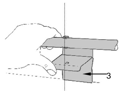
Richten Sie die unteren Montageelemente (3) so aus, daß die Vierkantstanzungen der unteren Montageelemente (3) genau unter den Bohrungen des Trägerrohres liegen.
