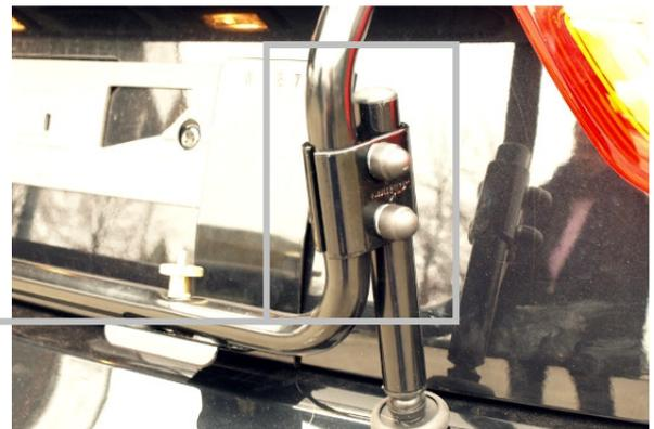
6. Befestigen Sie die Belastungsverstärker (5) gemäß Abbildung. Sie müssen fest auf der Stoßstange aufstehen. Bitte kleben Sie die Lackschutzfolien (26) unterhalb der Gelenkfüße im Bereich des Druckpunktes auf die Stoßstange.
