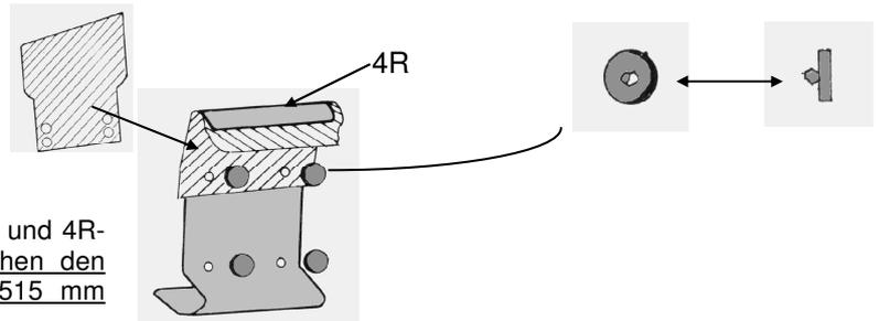
2. Hängen Sie die oberen Montageelemente (4L-Links und 4R-Rechts) in die Heckklappe ein. Der Abstand zwischen den Innenkanten der oberen Montageelemente muß 515 mm betragen. Siehe Abb.
