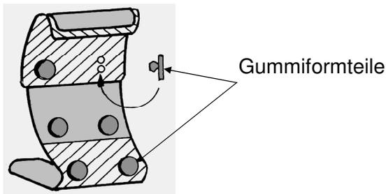
Die Montageelemente werden im Abstand von **12 mm** neben den Heckklappenscharnieren eingehängt.
