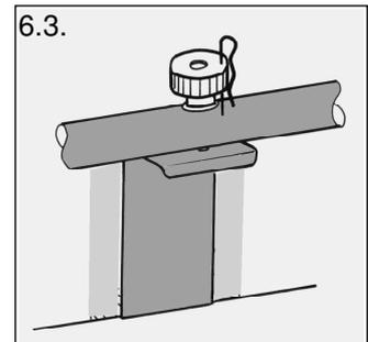
6.3. Verspannen Sie die unteren Montageelemente mit dem Trägergestell. Hierzu drehen Sie die Rändelmuttern bis zum Anschlag fest und sichern Sie die Rändelmuttern gegen Losdrehen mit dem Sicherungssplint.
