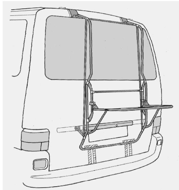
Bei abgenommenen Träger kann ein verrutschtes Montageelement beim Öffnen der Heckklappe verkanten und zu Schäden an Ihrem Fahrzeug führen.
