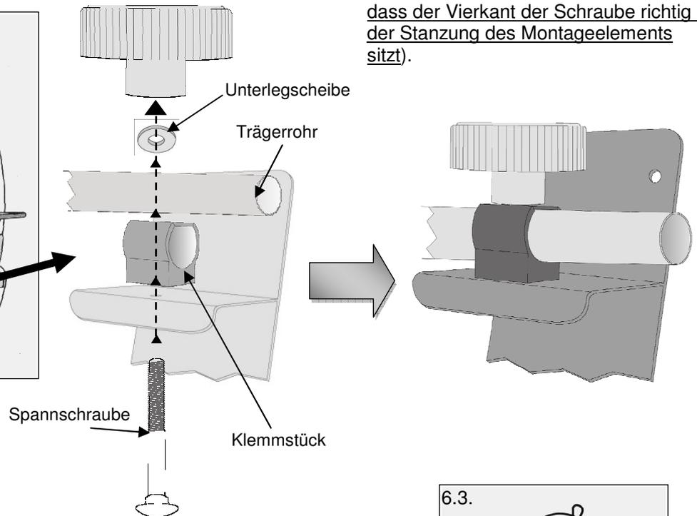
Führen Sie die Spannschrauben durch die Öffnungen von Montageelementen, Klemmstück und Trägerrohr (Achten Sie darauf, dass der Vierkant der Schraube richtig in der Stanzung des Montageelements sitzt).
