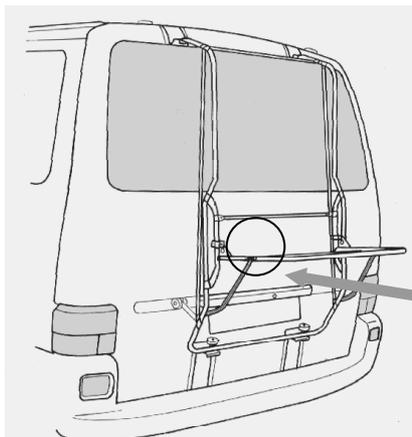
7. Lösen Sie die Versteifungsstreben aus ihren Halterungen und klappen Sie sie soweit nach vorn, bis die Verbindung mit den Zapfen am Lastenrahmen möglich wird. Abschließend müssen die Zapfen mit den Splinten gesichert werden.
