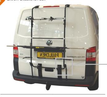
Hinweis: Befestigen Sie die Belastungsverstärker unbedingt bei geschlossener Heckklappe gemäß Abbildung. Sie müssen fest auf der Stoßstange aufstehen, ohne sie einzudrücken.
