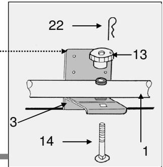
4. Befestigen Sie die Gummiformteile (24) an den unteren Montageelementen gem. Abb. und hängen Sie sie in die leicht geöffnete Heckklappe ein. Richten Sie die unteren Montageelemente (3) so aus, daß die Vierkantstanzungen der unteren Montageelemente (3) genau unter den Bohrungen des Trägerrohres liegen.
