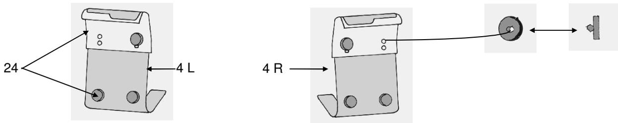
2. Hängen Sie die oberen Montageelemente L-Links, R-Rechts in die halb geöffnete Heckklappe ein. Der Abstand zwischen den Innenkanten der oberen Montageelemente muß 540 mm betragen. Siehe Abb.
