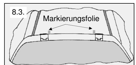
8.3. Die oberen Montageelemente können bei halb geöffneter Heckklappe ausgehängt werden.
