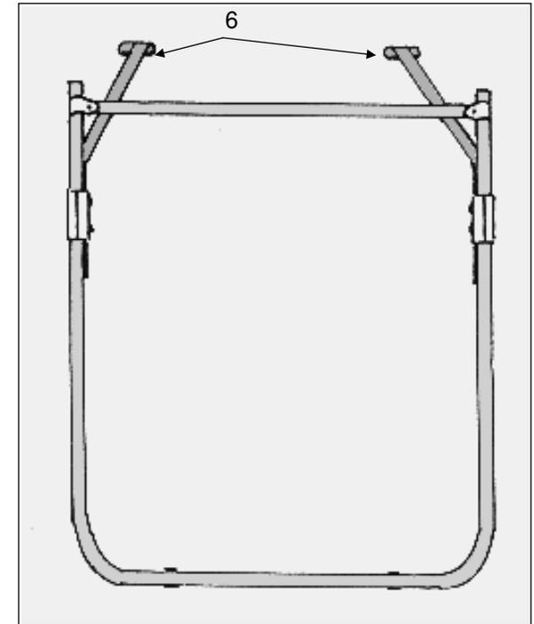
3.4. Die Trägerlänge ist jetzt fahrzeugspezifisch genau angepasst. Schwenken Sie die Tragarme (6) etwas nach innen ein und hängen Sie das Trägergestell (1) anschließend in die Aufnahme der oberen Montageelemente (4L und 4R) .
