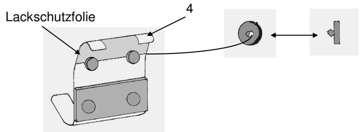
2. Hängen Sie die oberen Montageelemente (4) in die halb geöffnete Heckklappe ein. Der Abstand zwischen den Innenkanten der oberen Montageelemente muß 575 mm betragen. Siehe Abb.
