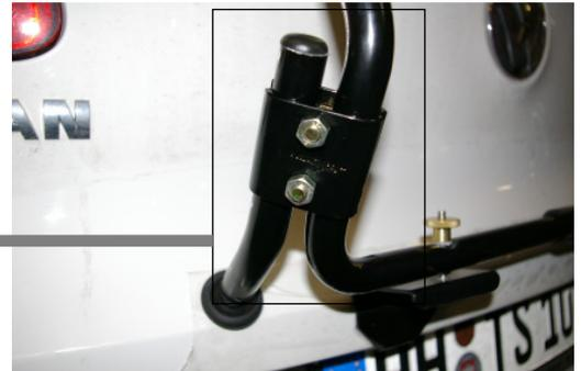
7. Befestigen Sie die Belastungsverstärker (5) gemäß Abbildung. Sie müssen fest an der Heckklappe anliegen. Bitte kleben Sie die Lackschutzfolien (26) unterhalb der Gelenkfüße im Bereich des Druckpunktes auf die Heckklappe.
