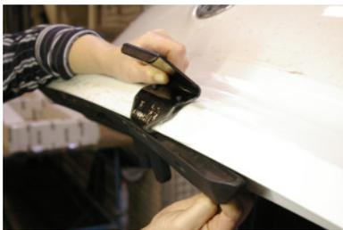
9.3. Die oberen Montageelemente können bei halb geöffneter Heckklappe ausgehängt werden.
