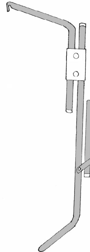
3.4. Die Trägerlänge ist jetzt fahrzeugspezifisch genau angepasst. Hängen Sie das Trägergestell (1) anschließend in die Aufnahme der oberen Montageelemente (4).
