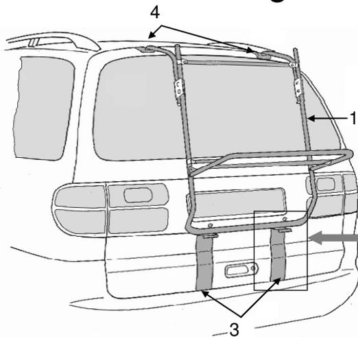
4. Befestigen Sie die Gummiformteile (24) an den unteren Montageelementen gem. Abb. und hängen Sie sie in die leicht geöffnete Heckklappe ein. Richten Sie die unteren Montageelemente (3) so aus, daß die Vierkantstanzungen der unteren Montageelemente (3) genau unter den Bohrungen des Trägerrohres liegen.
