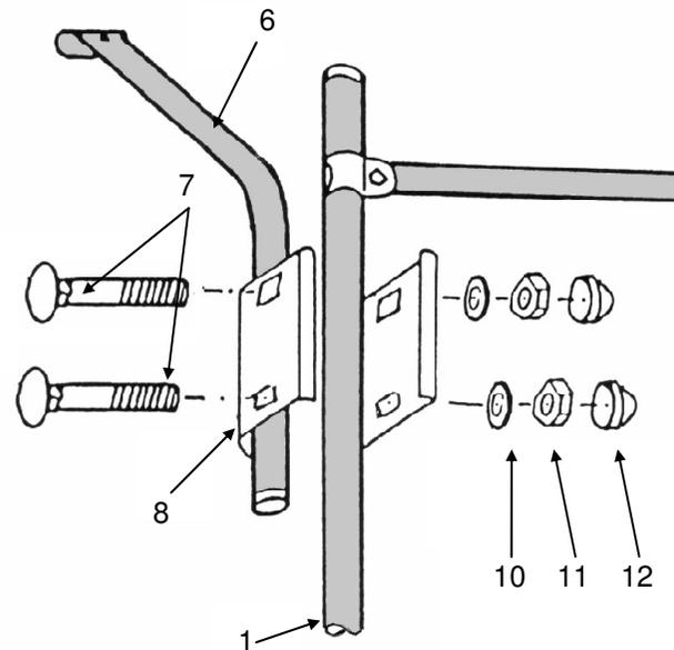
3.3. Stecken Sie die Gurthalter über die oberen Schloßschrauben und umschließen Sie die verbundenen Rohre mit den Klemmböcken (8) gem. Abb. und ziehen die Muttern (11) vorerst nur leicht an.
