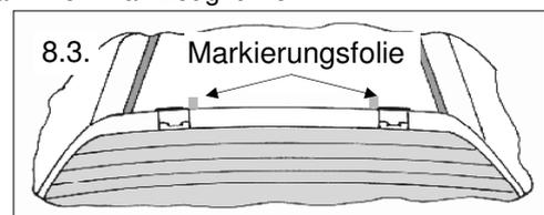
8.3. Die oberen Montageelemente können bei halb geöffneter Heckklappe ausgehängt werden.
