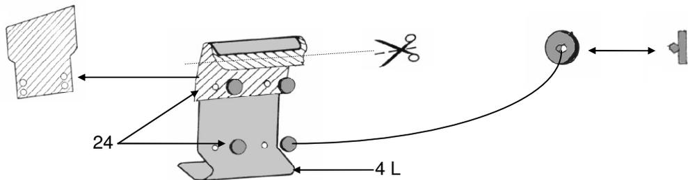
2. Hängen Sie die oberen Montageelemente L-Links, R-Rechts in die halb geöffnete Heckklappe ein. **Der Abstand zwischen den Innenkanten der oberen Montageelemente muß 530 mm betragen. Siehe Abb.**
