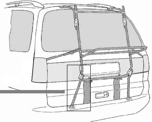
7. Befestigen Sie die Belastungsverstärker (5) gemäß Abbildung. Sie müssen fest auf der Stoßstange aufstehen. Bitte kleben Sie die Lackschutzfolien (26) unterhalb der Gelenkfüße im Bereich des Druckpunktes auf die Stoßstange.
