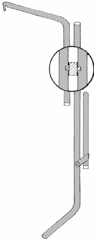
3.2. Der Fixierstift (F) ist werkseitig in die richtige Position eingepreßt. Die Lochposition sollte unter keinen Umständen verändert werden.
