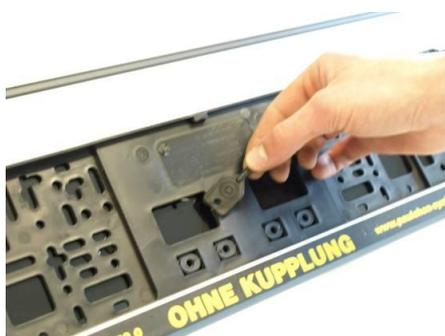
1. Brechen Sie das Hilfswerkzeug aus der Blende gem. Abb. heraus.
