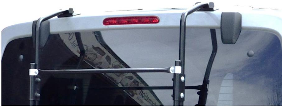
Hängen Sie die oberen Montageelemente bei geschlossener Heckklappe, auf der Ausbuchtung des Scharniers ein.
