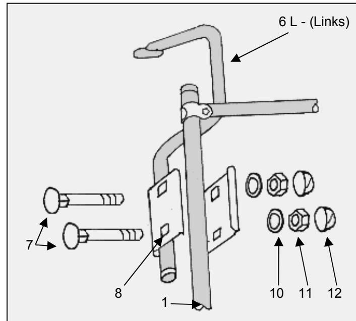
3.3. Danach umschließen Sie die verbundenen Röhre mit den Klemmböcken (8) gem. Abb, und ziehen die Muttern (11) vorerst nur leicht an.
