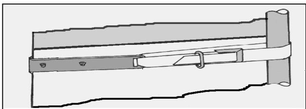
9.1. Lösen Sie die Spannung der Querlasthaltebänder und hängen Sie sie anschließend bei leicht geöffneter Heckklappe aus.
