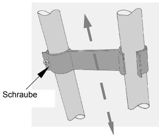
Nach dem Sie den Rahmenhalter positioniert haben, ziehen Sie die Schraube an.
