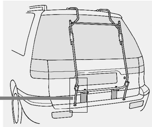
6. Befestigen Sie die Belastungsverstärker (5) gemäß Abbildung. Sie müssen fest auf der Stoßstange aufstehen. Bitte kleben Sie die Lackschutzfolien (26) unterhalb der Gelenkfüße im Bereich des Druckpunktes auf die Stoßstange.
