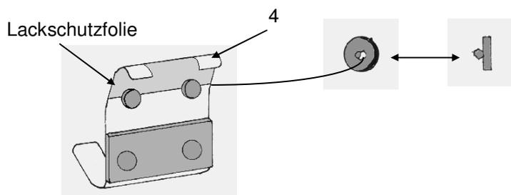
2. Hängen Sie die oberen Montageelemente (4) in die halb geöffnete Heckklappe ein. Der Abstand zwischen den Innenkanten der oberen Montageelemente muß 330 mm betragen. Siehe Abb.
