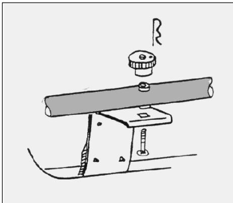
9.3. Die oberen Montageelemente können bei halb geöffneter Heckklappe ausgehängt werden.
