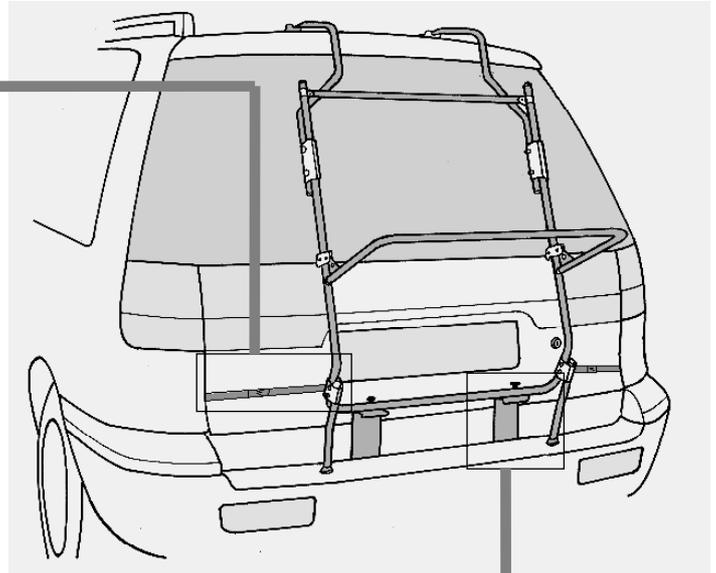
9.2. Ziehen Sie die Sicherungssplinte und schrauben Sie die Rändelmuttern von den Spannschrauben (Tip: Verkantete Spannschrauben lassen sich leicht lösen, wenn man die Montageelemente und das Trägerrohr etwas gegeneinander drückt). Anschließend können Sie das Trägergestell aushängen.
