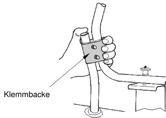
Drücken Sie die Belastungsverstärker nach unten, während Sie die Muttern an den Klemmbacken anziehen.
