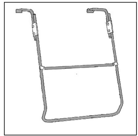
3.4. Die Trägerlänge ist jetzt fahrzeugspezifisch genau angepasst. Hängen Sie das Trägergestell (1) anschließend in die Aufnahme der oberen Montageelemente (4) .
