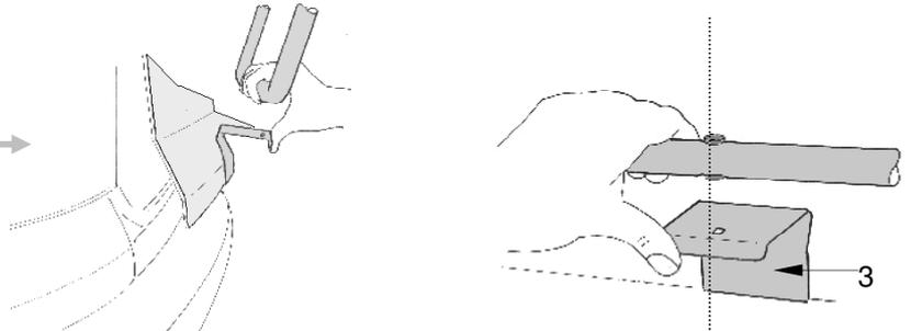
Führen Sie nun die Spannschrauben (14) durch die Öffnungen von Montageelementen und Trägerrohr (Achten Sie darauf, daß der Vierkant der Schraube richtig in der Stanzung des Montageelements sitzt).
