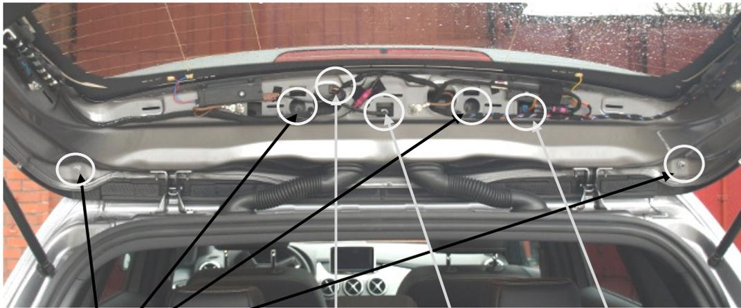
Öffnen Sie die Heckklappe und entfernen Sie die Verkleidung. (s. Abb. 1.1)
