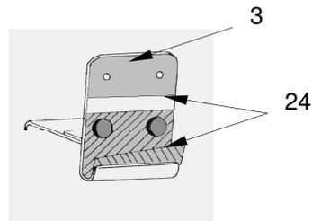
5. Hängen Sie die Elemente in die leicht geöffnete Heckklappe ein siehe Abb. 5.1
