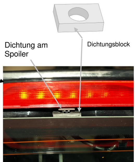
Die selbstklebenden Gummi-zuschnitte und die **transparenten Lackschutzfolien** wurden bereits werkseitig **eingeklebt und dürfen keinesfalls entfernt werden.**
