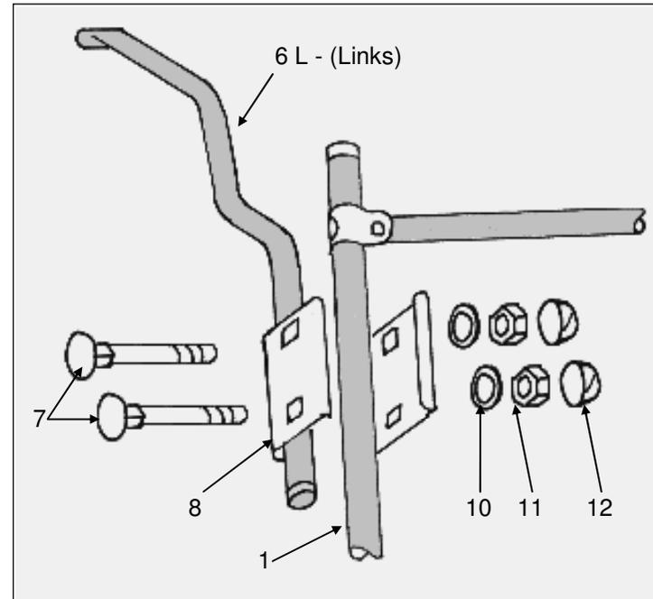
3.3. Danach umschließen Sie die verbundenen Rohre mit den Klemmböcken (8) gem. Abb, und ziehen die Muttern (11) vorerst nur leicht an.
