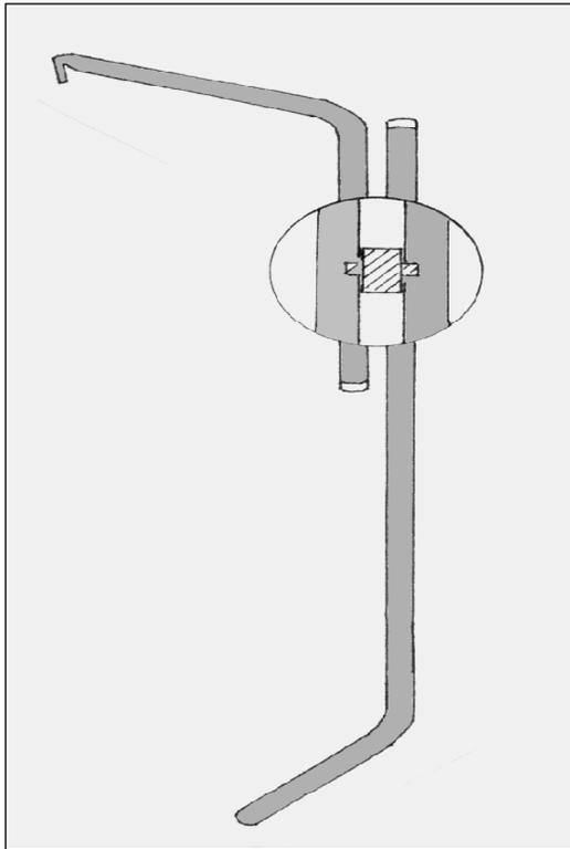
3.2. Der Fixierstift (F) ist werkseitig in die richtige Position eingepreßt. Die Lochposition sollte unter keinen Umständen verändert werden.
