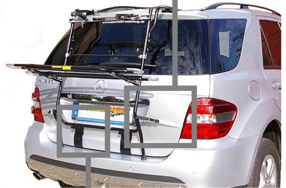
9.2. Ziehen Sie die Sicherungssplinte und schrauben Sie die Rändelmuttern von den Spannschrauben (Tip: Verkantete Spannschrauben lassen sich leicht lösen, wenn man die Montageelemente und das Trägerrohr etwas gegeneinander drückt). Anschließend können Sie das Trägergestell aushängen.
