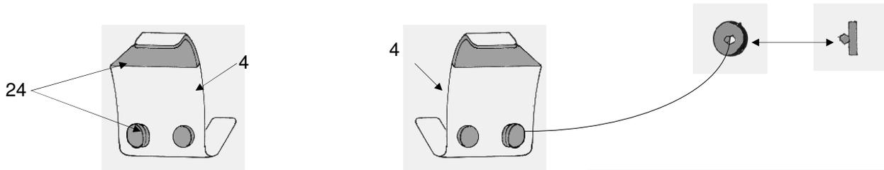
2. Hängen Sie die oberen Montageelemente in die halb geöffnete Heckklappe ein. Der Abstand zwischen den Innenkanten der oberen Montageelemente muß 580 mm betragen. Siehe Abb.
