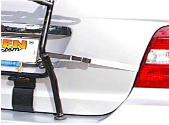
9.1. Lösen Sie die Spannung der Querlasthaltebänder und hängen Sie sie anschließend bei leicht geöffneter Heckklappe aus.
