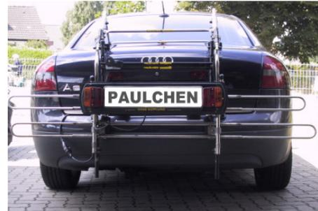
Vor Öffnen der Heckklappe mit montierem Tieflader unbedingt die Steckverbindung der Zusatzbeleuchtung **trennen**. Siehe Abb.
