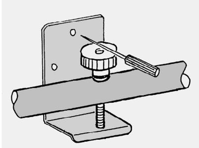
Markieren Sie die Bohrpunkte. Die markierten Löcher werden mit einem 2,7 mm Bohrer vorgebohrt.
