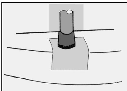
6. Befestigen Sie die Belastungsverstärker (5) gemäß Abbildung. Sie müssen fest auf der Stoßstange aufstehen. Bitte kleben Sie die Lackschutzfolien (26) unterhalb der Gummipuffer im Bereich des Druckpunktes auf die Stoßstange.
