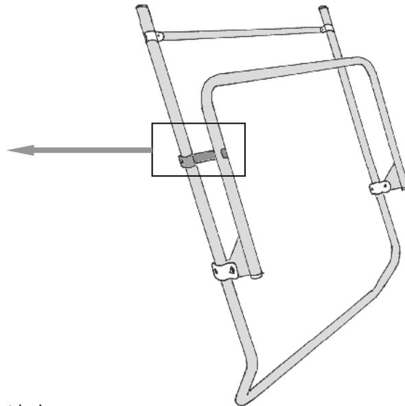
Nach dem Sie den Rahmenhalter positioniert haben, ziehen Sie die Schraube an.
