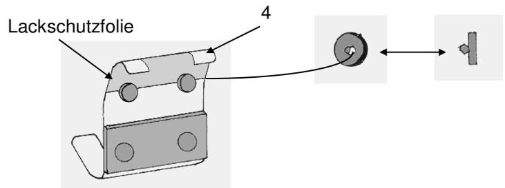
2. Hängen Sie die oberen Montageelemente (4) in die halb geöffnete Heckklappe ein. Der Abstand zwischen den Innenkanten der oberen Montageelemente muß 480 mm betragen. Siehe Abb.
