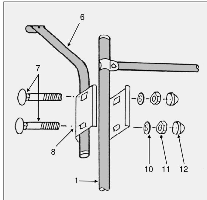
3.3. Danach umschließen Sie die verbundenen Rohre mit den Klemmböcken (8) gem. Abb, und ziehen die Muttern (11) vorerst nur leicht an.
