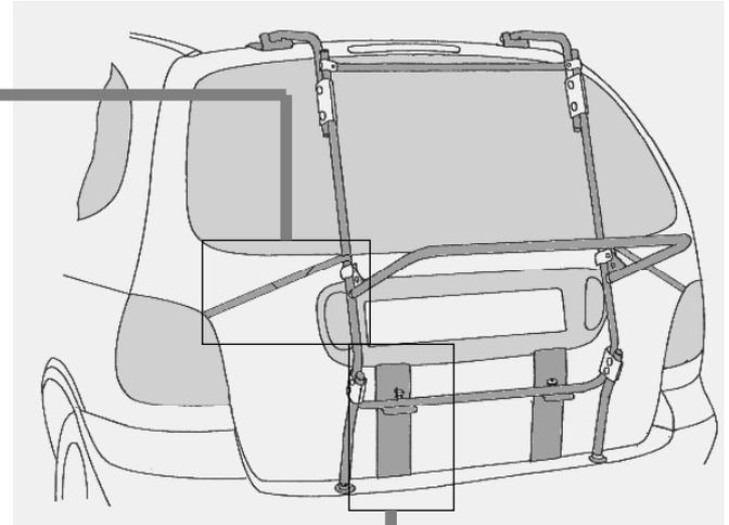
9.2. Ziehen Sie die Sicherungssplinte und schrauben Sie die Rändelmuttern von den Spannschrauben (Tip: Verkantete Spannschrauben lassen sich leicht lösen, wenn man die Montageelemente und das Trägerrohr etwas gegeneinander drückt). Anschließend können Sie das Trägergestell aushängen.
