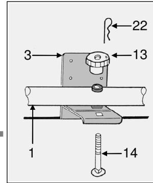
4. Befestigen Sie die Gummiformteile (24) an den unteren Montageelementen gem. Abb. und hängen Sie sie in die leicht geöffnete Heckklappe ein. Richten Sie die unteren Montageelemente (3) so aus, daß die Vierkantstanzungen der unteren Montageelemente (3) genau unter den Bohrungen des Trägerrohres liegen.
