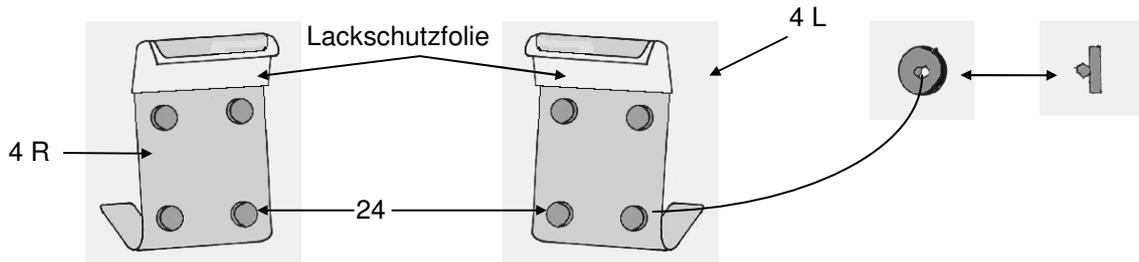
2. Hängen Sie die oberen Montageelemente (4L-Links und 4R-Rechts)) in die halb geöffnete Heckklappe ein.
