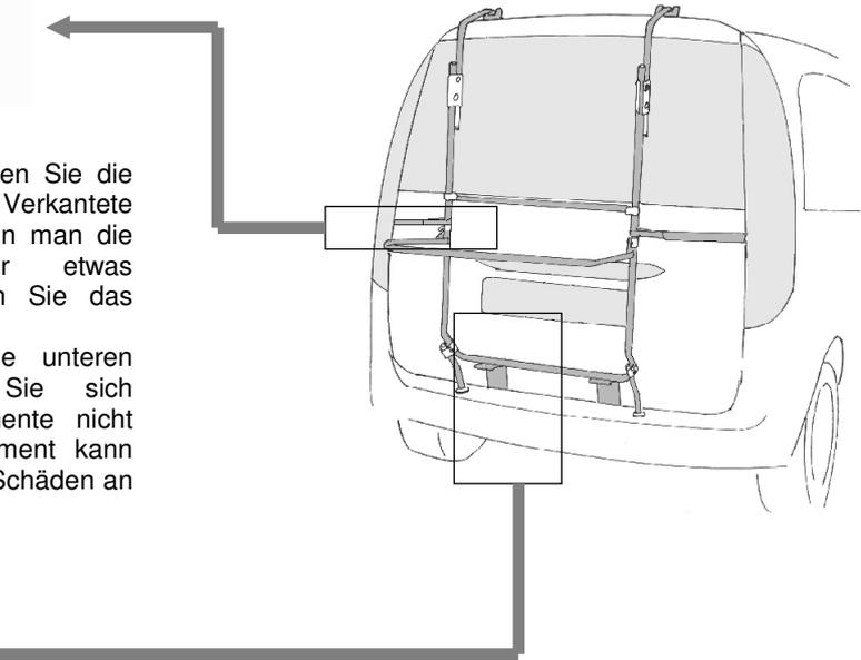
Die oberen Montageelemente können bei halb geöffneter Heckklappe ausgehängt werden.
