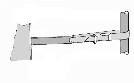
Lösen Sie die Spannung der Querlasthaltebänder und hängen Sie sie anschließend bei leicht geöffneter Heckklappe aus.
