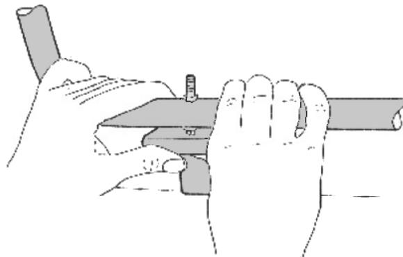
Hierzu drehen Sie nun die Rändelmutter (13) so weit an, bis das Trägerrohr auf den unteren Montageelementen (3) aufliegt. Hierdurch wird der Träger gespannt und erhält seine Stabilität. Jetzt werden die Muttern (11) an den Klemmböcken (8 Siehe Punkt 3) fest angezogen. Die Muttern dürfen bis max. 11 Nm angezogen werden.
