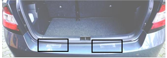
4. Befestigen Sie die Gummiformteile (24) an den unteren Montageelementen. Bei einigen Montageelementen wurden bereits werkseitig Lackschutzfolien eingeklebt, die keinesfalls entfernt werden dürfen (die Form kann von den abgebildeten Winkeln abweichen).
