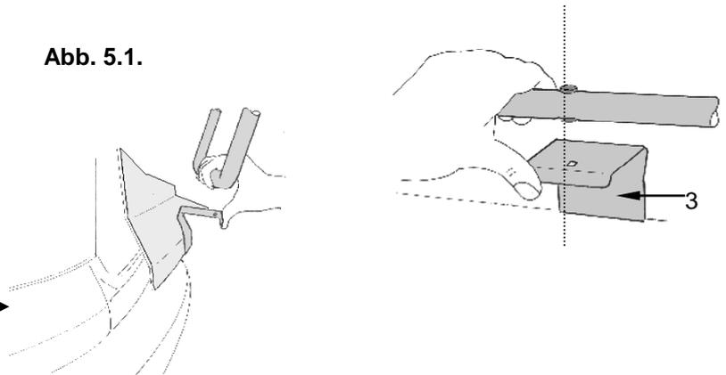
Führen Sie nun die Spannschrauben (14) durch die Öffnungen von Montageelementen und Trägerrohr (Achten Sie darauf, daß der Vierkant der Schraube richtig in der Stanzung des Montageelements sitzt).
