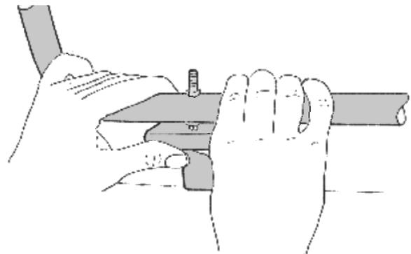
Hierzu drehen Sie nun die Rändelmutter (13) so weit an, bis das Trägerrohr auf den unteren Montageelementen (3) aufliegt. Hierdurch wird der Träger gespannt und erhält seine Stabilität. Jetzt werden die Mutter (11) an den Klemmböcken (8 Siehe Punkt 3) fest angezogen. Die Mutter dürfen bis max. 11 Nm angezogen werden.
