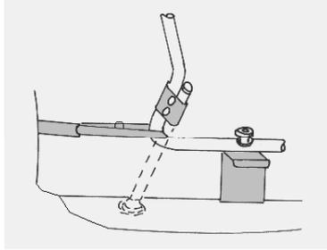
Lösen Sie die Spannung der Querlasthaltebänder und hängen Sie sie anschließend bei leicht geöffneter Heckklappe aus.
