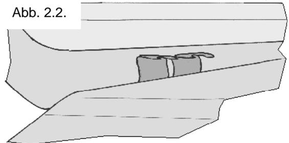
**Wichtiger Hinweis:** Halten Sie die Montageelemente beim Öffnen und Schließen der Heckklappe fest. Ein verrutschtes Montageelement kann beim Öffnen der Heckklappe verkanten und zu Schäden an Ihrem Fahrzeug führen.
