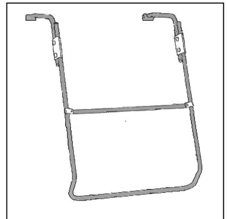
3.4. Die Trägerlänge ist jetzt fahrzeugspezifisch genau angepasst. Hängen Sie das Trägergestell (1) anschließend in die Aufnahme der oberen Montageelemente (4) .
