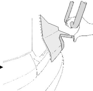
Richten Sie die unteren Montageelemente (3) so aus, daß die Vierkantstanzungen der unteren Montageelemente (3) genau unter den Bohrungen des Trägerrohres liegen.
