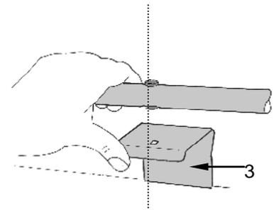
Führen Sie nun die Spannschrauben (14) durch die Öffnungen von Montageelementen und Trägerrohr (Achten Sie darauf, daß der Vierkant der Schraube richtig in der Stanzung des Montageelements sitzt).
