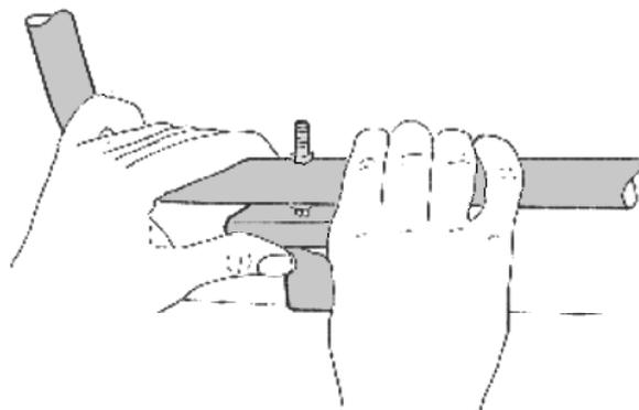
Hierzu drehen Sie nun die Rändelmutter (13) so weit an, bis das Trägerrohr auf den unteren Montageelementen (3) aufliegt. Hierdurch wird der Träger verspannt und erhält seine Stabilität. Jetzt werden die Muttern (11) an den Klemmböcken (8 Siehe Punkt 3) fest angezogen. Die Muttern dürfen bis max. 11 Nm angezogen werden.
