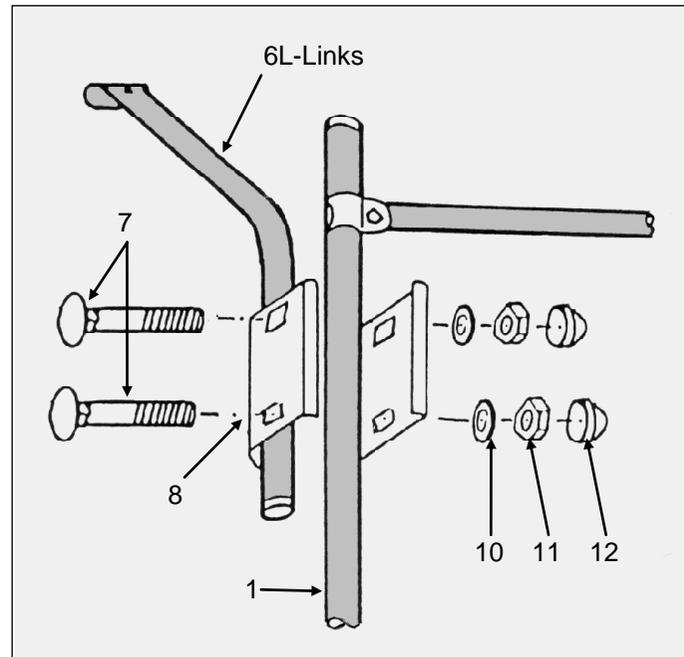
3.3. Danach umschließen Sie die verbundenen Rohre mit den Klembacken (8) gem. Abb, und ziehen die Muttern (11) vorerst nur leicht an.
