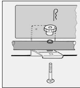
4. Befestigen Sie die Gummiformteile (24) an den unteren Montageelementen. Bei einigen Montageelementen wurden bereits werkseitig Lackschutzfolien eingeklebt, die keinesfalls entfernt werden dürfen (die Form kann von den abgebildeten Winkeln abweichen). Hängen Sie die Elemente in die leicht geöffnete Heckklappe ein siehe Abb. 4.1, Richten Sie die unteren Montageelemente (3) so aus, daß die Vierkantstanzungen der unteren Montageelemente (3) genau unter den Bohrungen des Trägerrohres liegen.
