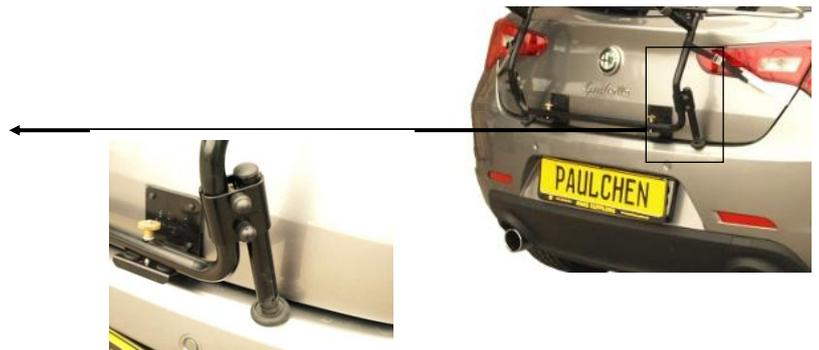
6. Befestigen Sie die Belastungsverstärker (5) gemäß Abbildung. Sie müssen fest auf der Stoßstange aufstehen. Bitte kleben Sie die Lackschutzfolien (26) unterhalb der Gelenkfüße im Bereich des Druckpunktes auf die Stoßstange.
