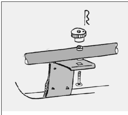
9.3. Die oberen Montageelemente können bei halb geöffneter Heckklappe ausgehängt werden.
