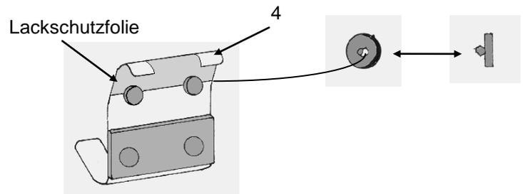
2. Hängen Sie die oberen Montageelemente (4) in die halb geöffnete Heckklappe ein. Der Abstand zwischen den Innenkanten der oberen Montageelemente muß 610 mm betragen. Siehe Abb.
