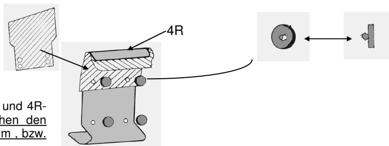
2. Hängen Sie die oberen Montageelemente (4L-Links und 4R-Rechts). in die Heckklappe ein. Der Abstand zwischen den Innenkanten der oberen Montageelemente muß 560 mm , bzw. 590 mm (mit Spoiler) betragen. Siehe Abb.
