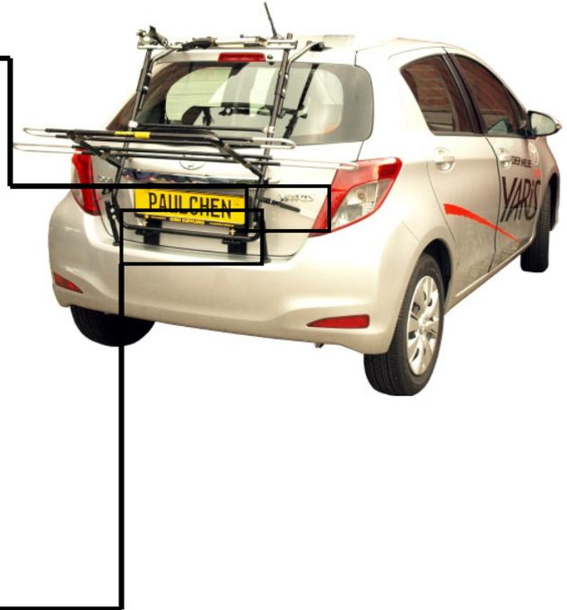
9.2. Ziehen Sie die Sicherungssplinte und schrauben Sie die Rändelmuttern von den Spannschrauben (Tip: Verkantete Spannschrauben lassen sich leicht lösen, wenn man die Montageelemente und das Trägerrohr etwas gegeneinander drückt). Anschließend können Sie das Trägergestell aushängen.
