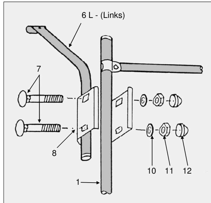
3.3. Danach umschließen Sie die verbundenen Rohre mit den Klemmbacken (8) gem. Abb, und ziehen die Muttern (11) vorerst nur leicht an.
