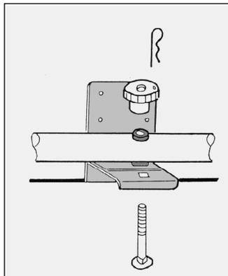
9.3. Die oberen Montageelemente können bei halb geöffneter Heckklappe ausgehängt werden.
