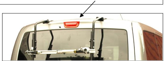
2. Hängen Sie die oberen Montageelemente (4) in die halb geöffnete Heckklappe ein. Der Abstand zwischen den Innenkanten der oberen Montageelemente muß 545 mm betragen. Siehe Abb.
