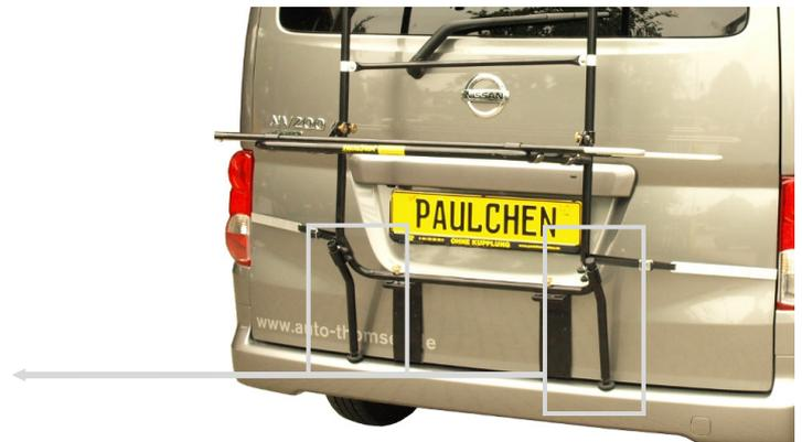
6. Befestigen Sie die Belastungsverstärker (5) gemäß Abbildung. Sie müssen fest auf der Stoßstange aufstehen. Bitte kleben Sie die Lackschutzfolien (26) unterhalb der Gelenkfüße im Bereich des Druckpunktes auf die Stoßstange.
