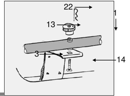
4. Die Gummiformteile (24) an den unteren Montageelementen (3) sind bereits werkseitig angebracht.
