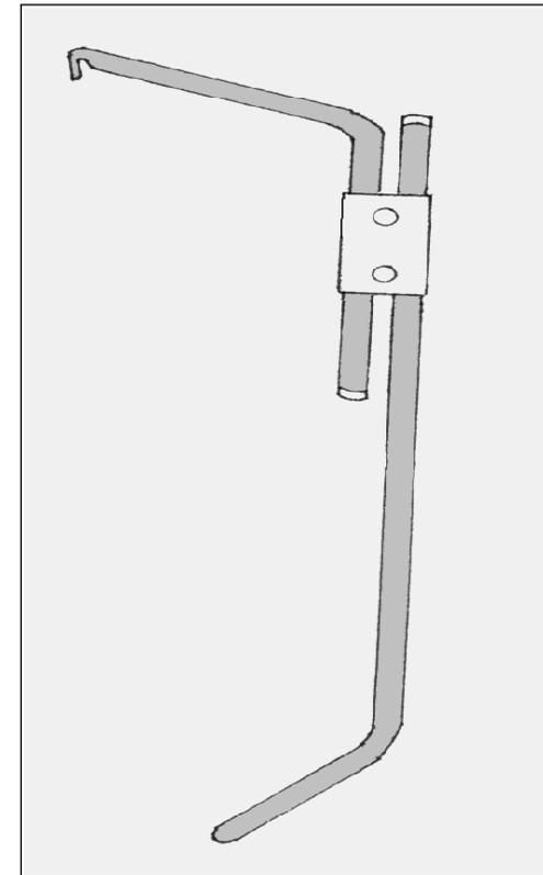
3.4. Die Trägerlänge ist jetzt fahrzeugspezifisch genau angepasst. Hängen Sie das Trägergestell (1) anschließend in die Aufnahme der oberen Montageelemente (4).
