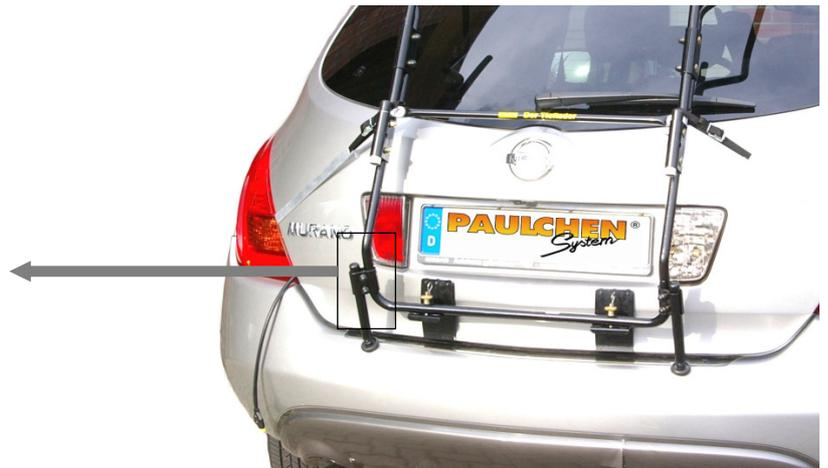
6. Befestigen Sie die Belastungsverstärker (5) gemäß Abbildung. Sie müssen fest auf der Stoßstange aufstehen. Bitte kleben Sie die Lackschutzfolien (26) unterhalb der Gelenkfüße im Bereich des Druckpunktes auf die Stoßstange.
