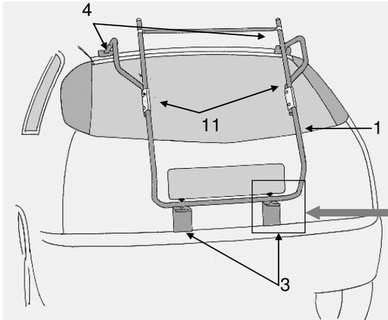
4. Die Gummiformteile (24) an den unteren Montageelementen (3) sind bereits werkseitig angebracht.
