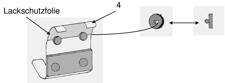
2. Hängen Sie die oberen Montageelemente (4) in die halb geöffnete Heckklappe ein. Der Abstand zwischen den Innenkanten der oberen Montageelemente muß 825 mm betragen. Siehe Abb.
