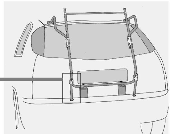
6. Befestigen Sie die Belastungsverstärker (5) gemäß Abbildung. Sie müssen fest auf der Stoßstange aufstehen. Bitte kleben Sie die Lackschutzfolien (26) unterhalb der Gelenkfüße im Bereich des Druckpunktes auf die Stoßstange.
