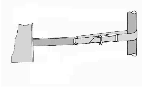
9.1. Lösen Sie die Spannung der Querlasthalterbänder und hängen Sie sie anschließend bei leicht geöffneter Heckklappe aus.
