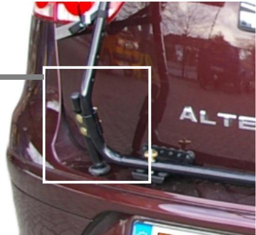
6. Befestigen Sie die Belastungsverstärker (5) gemäß Abbildung. Sie müssen fest auf der Stoßstange aufstehen. Bitte kleben Sie die Lackschutzfolien (26) unterhalb der Gelenkfüße im Bereich des Druckpunktes auf die Stoßstange.
