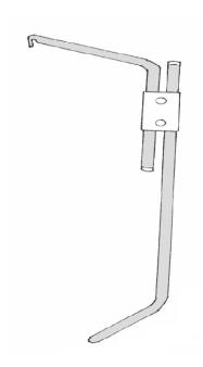
3.4. Die Trägerlänge ist jetzt fahrzeugspezifisch genau angepasst. Hängen Sie das Trägergestell (1) anschließend in die Aufnahme der oberen Montageelemente (4).
