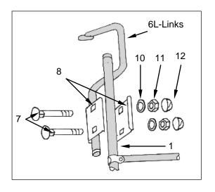
3.3. Danach umschließen Sie die verbundenen Rohre mit den Klemmbacken (8) gem. Abb, und ziehen die Muttern (11) vorerst nur leicht an, damit sich beim späteren Verspannen die Tragarme ausrichten können
