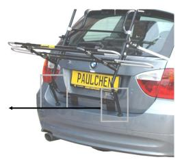
8. Befestigen Sie die Belastungsverstärker (5) gemäß Abbildung. Sie müssen fest auf der Stoßstange aufstehen. Bitte kleben Sie die Lackschutzfolien (26) unterhalb der Gelenkfüße im Bereich des Druckpunktes auf die Stoßstange.
