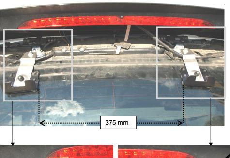
2. Lösen Sie jeweils die äußere Mutter an den Scharnieren (in keinem beide Muttern lösen). Setzen Sie die Montageelemente (auf links /rechts Kennzeichnung achten) auf die äußeren Gewinde auf und schrauben Sie sie mit den Originalmuttern fest.
