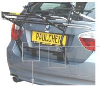
5. Richten Sie die unteren (3) Montageelemente so aus, daß die Vierkantstanzungen der unteren Montageelemente genau unter den Bohrungen des Trägerrohres liegen.
