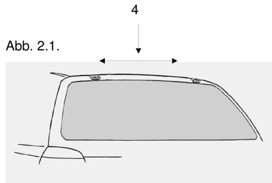
Wichtiger Hinweis: Halten Sie die Montageelemente beim Öffnen und Schließen der Heckklappe fest. Ein verrutschtes Montageelement kann beim Öffnen der Heckklappe verkanten und zu Schäden an Ihrem Fahrzeug führen.
