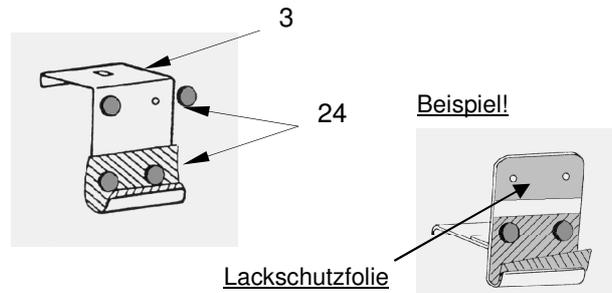
5. Hängen Sie die Elemente in die leicht geöffnete Heckklappe ein siehe Abb. 5.1
