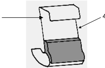
2. Die Montageelemente (4) werden bei halb geöffneter Heckklappe von der Mitte aus eingeschoben, siehe Abb. 2.1.
