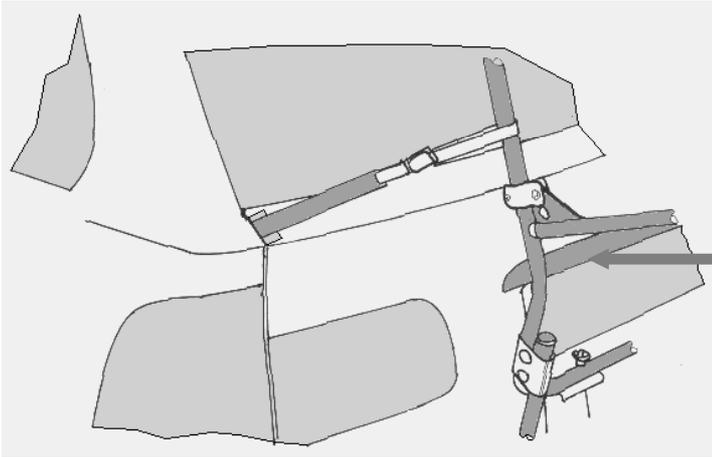
Lösen Sie die Spannung der Querlasthaltebänder und hängen Sie sie anschließend bei leicht geöffneter Heckklappe aus.
