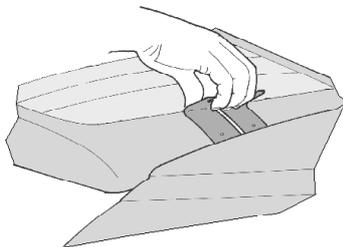
Anschließend verschieben Sie die Montageelemente bei geschlossener Hecktür seitlich (mittig ausrichten). Der Abstand zwischen den Innenkanten der oberen Montageelemente muß 520 mm betragen. Siehe Abb.
