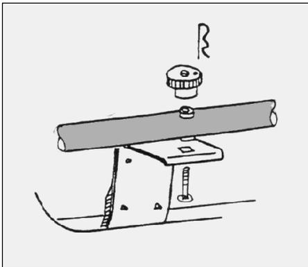
Die oberen Montageelemente können bei halb geöffneter Heckklappe ausgehängt werden.
