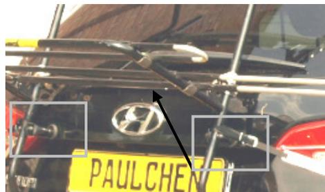
Kleben Sie im Bereich der Andruckfüße unbedingt die mitgelieferte Lackschutzfolie auf und achten Sie auf die genaue Position.
