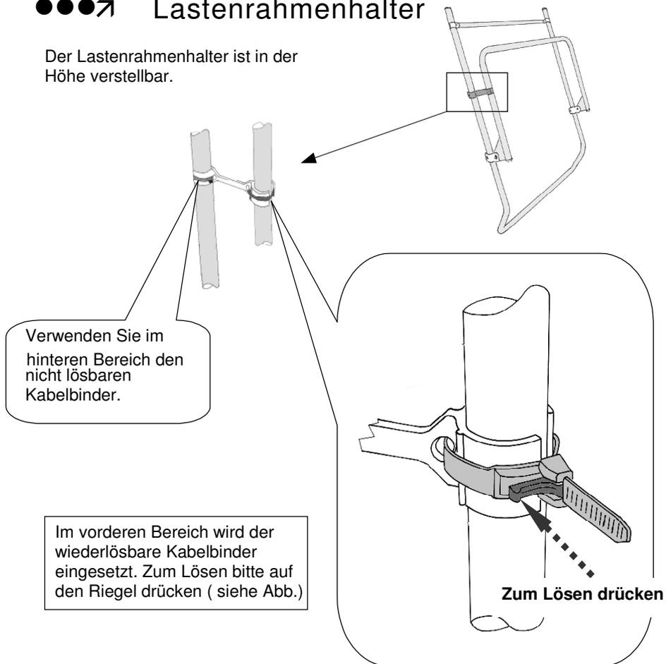
Dieser Halter **ersetzt** die in einigen Montageanleitungen abgebildeten älteren Versionen, bzw. die früher eingesetzten Gummispannbänder mit Kunststoffhaken.
