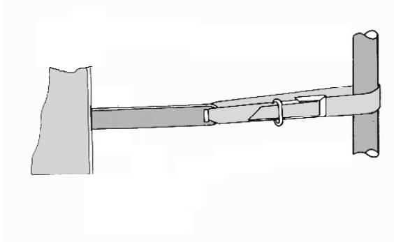
9.1. Lösen Sie die Spannung der Querlasthaltebänder und hängen Sie sie anschließend bei leicht geöffneter Heckklappe aus.
