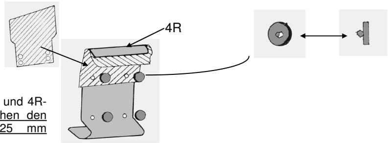
2. Hängen Sie die oberen Montageelemente (4L-Links und 4R-Rechts) in die Heckklappe ein. Der Abstand zwischen den Innenkanten der oberen Montageelemente muß 625 mm betragen. Siehe Abb.
