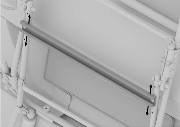
Sollte es erforderlich sein können Sie die vormontierte C-Schiene natürlich in eine der beiden anderen vorhandenen Bohrungen versetzen.
